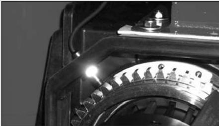
Das Einsatzgebiet von Magnetsensoren erweitert sich auch dadurch, dass viele nicht magnetische Metalle Magnetfelder ungehindert passieren lassen. Somit ist der Sensor einfach nur druckfest in einem stabilen Metallgehäuse zu kapseln. Er kann aber z. B. auch in Rohren oder hinter nicht magnetischen Metallflächen montiert werden.
