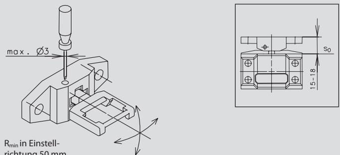
$R_{min}$  in Einstellrichtung 50 mm
