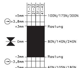
Die Angaben der Zugkraft sind vom verwendeten Typ abhängig. (SR...100/SR...175/SR...300)
