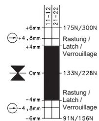
Die Angaben der Zugkraft sind vom verwendeten Typ abhängig. (SRM...175/SRM...300)
